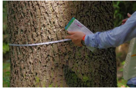
樹木の直径を図る巻尺:輪尺
